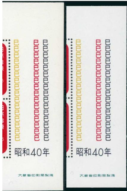
そもそも標準品の縦寸は1962年以前と63年以降では異なっていて、前者は90ミリ(切手3枚分)、後者は93.5ミリ(円筒状版面の周長の6分の1)となっています。前者は6シート大(横2×縦3)に仮裁断した大判シートを1段ずつ目打穿孔するのに、後者はロール紙に2列縦並びで印刷したシートを連続工程で目打穿孔(1シート分一括穿孔の全型目打)・裁断するのに都合よいサイズなのです。
